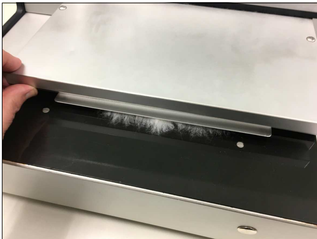
Figura 91. Inicio del ensayo. La probeta se mueve hacia el interior del equipo para que los cabezales escaneen la probeta
