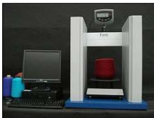
Figura 188. Sistema Forté con un cabezal para la medición individual de bobinas de hilo.
