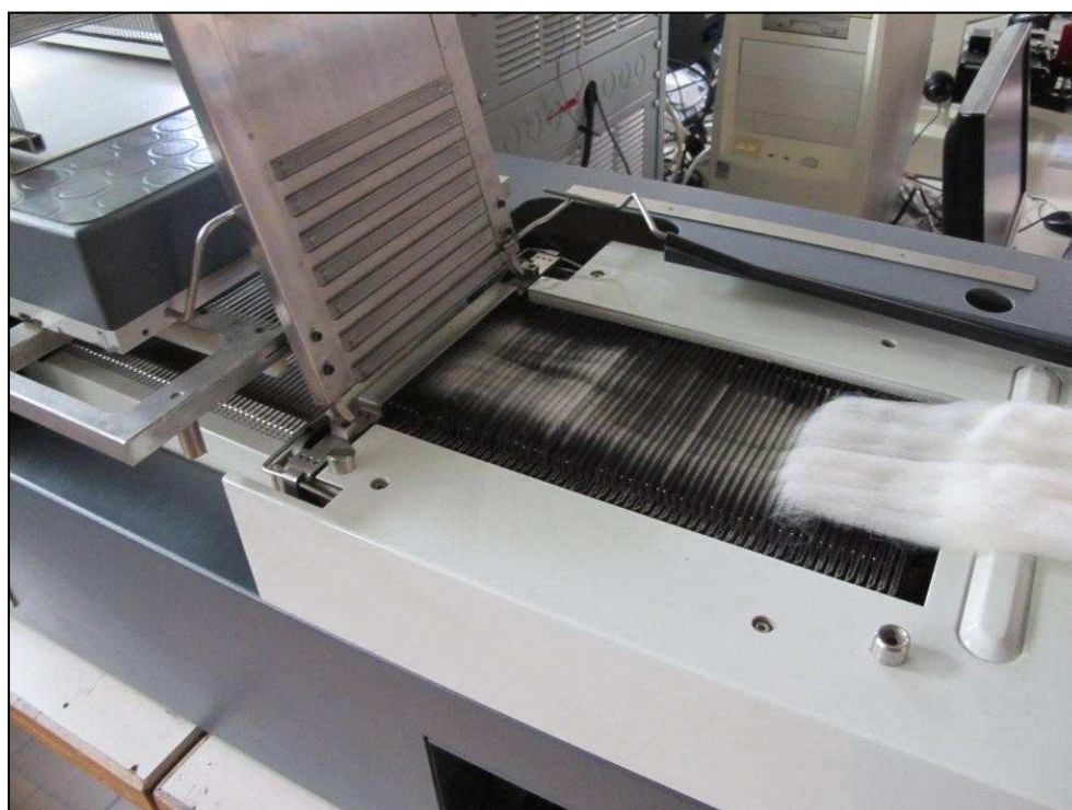
Figura 73. Lecho de peines del Fibroliner del ALMETER. Fuente: http://www.sav-biella.it/?p=340
