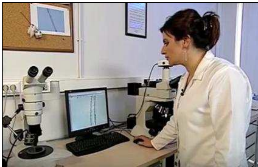
Figura 115. Microscopio óptico con sistema de digitalización de imágenes.
