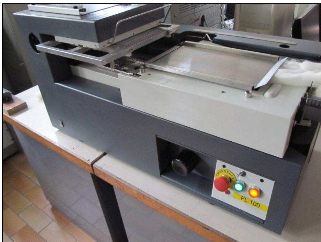
Figura 75. Lecho de peines del Fibroliner del ALMETER preparado para hacer la probeta.
