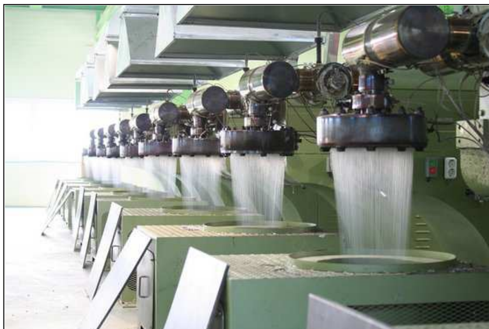
Figura 14. Línea de producción de cable. Véase el gran tamaño de las hileras.
