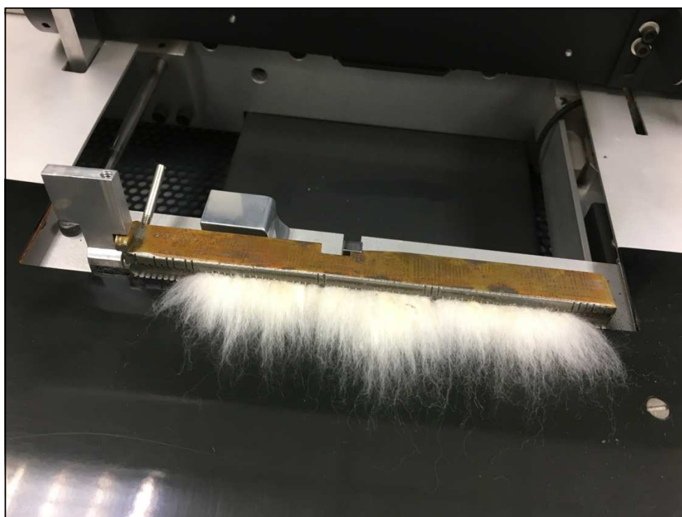
Figura 89. Probeta colocada en el equipo de medida tapando el cabezal emisor de luz
